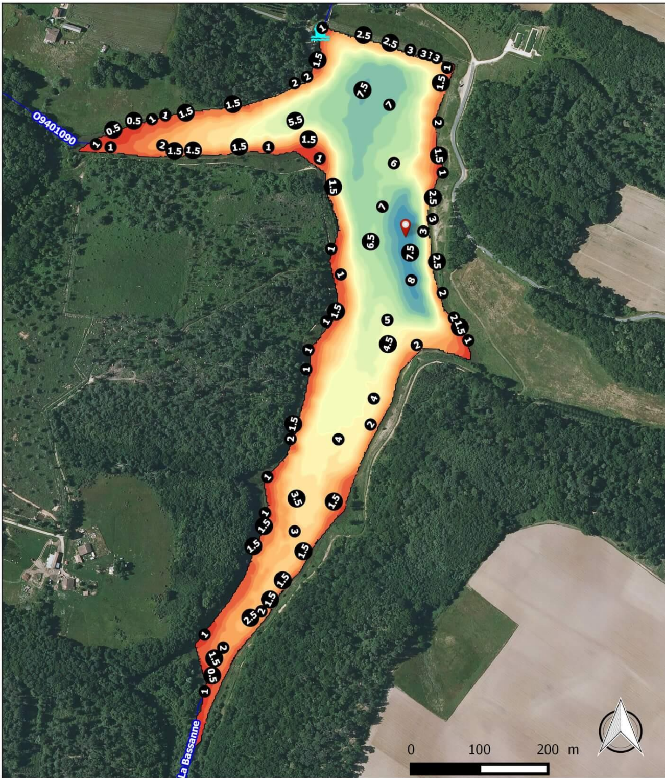
Cartographie de la bathymétrie du lac d'Aillas et Sigalens (mars 2015)
